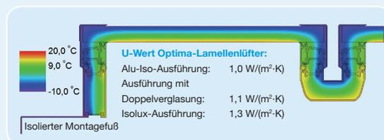
Die Abbildung illustriert den Wärmefluss mit einem Temperaturverlauf von -10 °C innen bis 20 °C außen. Flixo-U-Werte werden gemäß EN ISO 10077-2 bestimmt.
